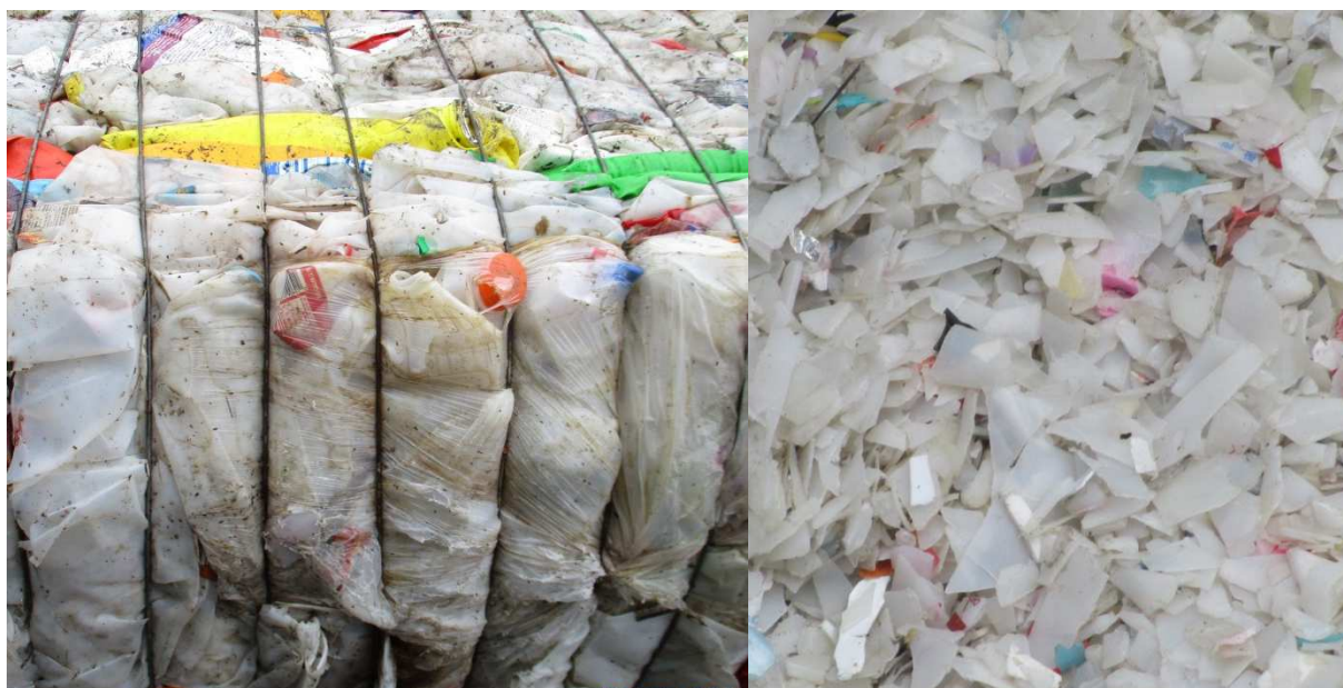
圖 3 「3915100006 乙烯聚合物之廢料、剝屑及碎片」進口廢塑膠現場照片
